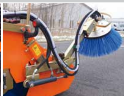
hydraulisch klappbarer Seitenkehrbesen
