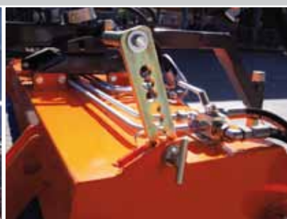
einfache Bürsteneinstellung über Rastersystem
