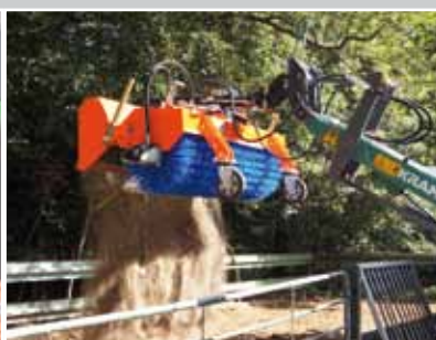
hydraulische Entleerung mit Freikehrmodus
