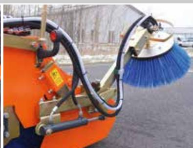
hydraulisch klappbarer Seitenkehrbesen
