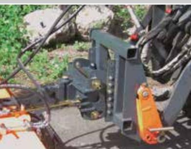
3D geführtes Aufnahmesystem
