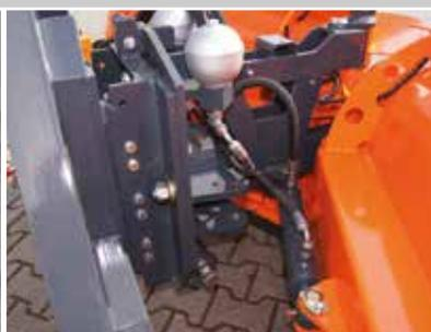
hydraulische Verstellung der Klappflügel
