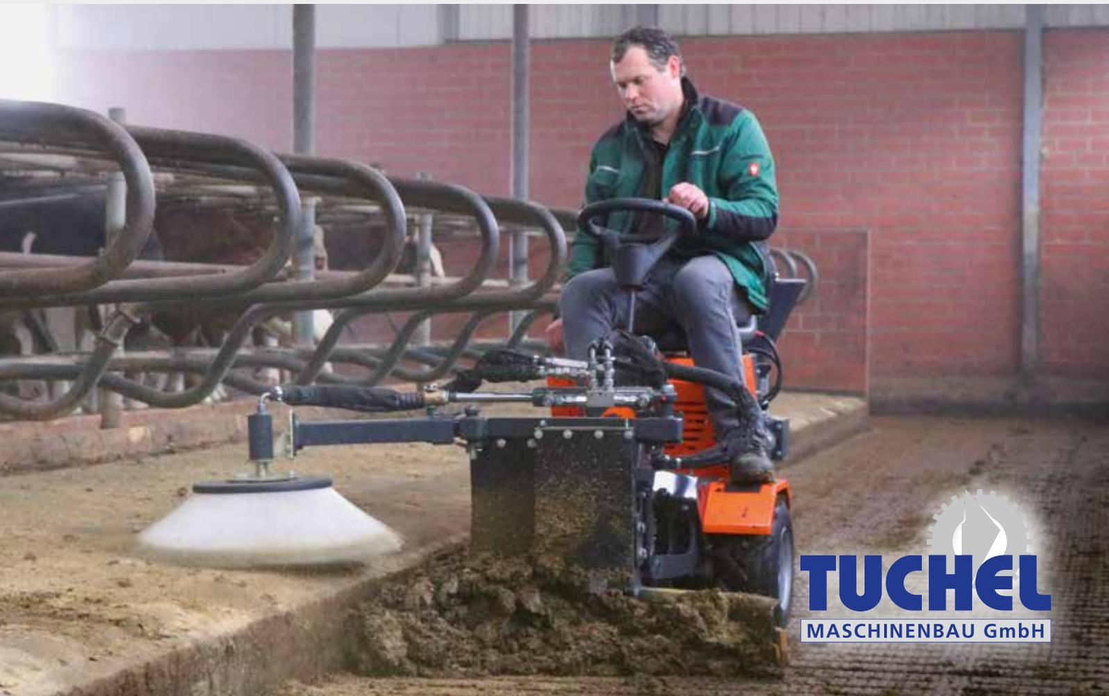
Klein, kompakt, wendig und zügig, das ist unser neuer **MINI 3**. Serienmäßig haben wir das Dreirad mit hydrostatischem Vorderradantrieb für Sie ausgerüstet. Durch die hintere Lenkachse hat der **MINI 3** einen Wenderadius von nur 490 mm. Dank der Schnellwechseleinrichtung ist die Montage und Demontage vieler Anbaugeräte für Sie sehr bedienerfreundlich. So sind viele Tätigkeiten rund um Ihren Hof leicht und zügig erledigt.
