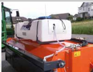
Wassersprüheinrichtung mit 100/200 Liter Wassertank
