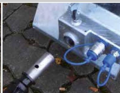
Schnellwechseleinrichtung u. doppelt wirkender Hydraulikanschluss serienmäßig
