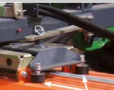
Niveaueingleich für optimale Boden Anpassung
