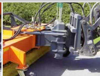
optimale Boden Anpassung durch robusten 3D-Niveaueingleich
