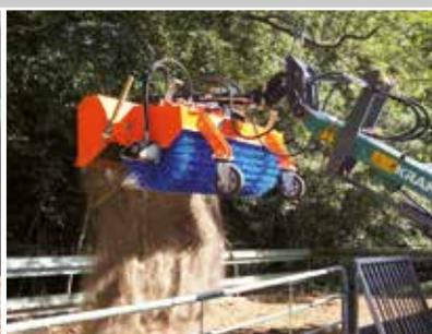
hydraulische Entleerung mit Freikehrmodus
