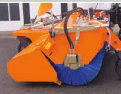
innenliegender Motor und Kehr-Keil-Optimierung
