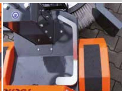
ergonomisch geformtes Fußpedal
