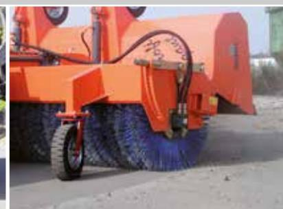
einfache Bürstennachstellung über Rasthebelsystem
