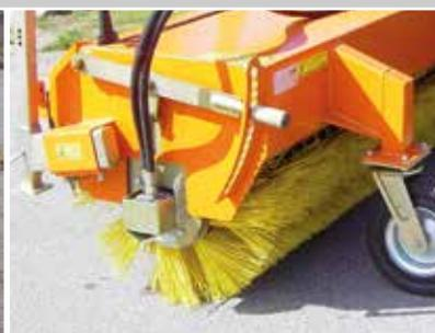
zwei leistungsstarke, innenliegende Motoren für den Bürstenantrieb
