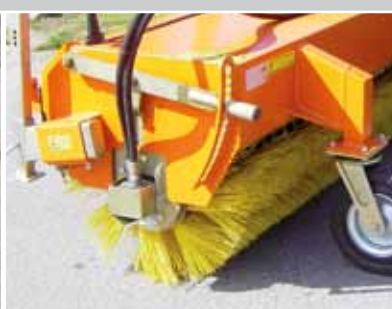
zwei leistungsstarke, innenliegende Motoren für den Bürstenantrieb
