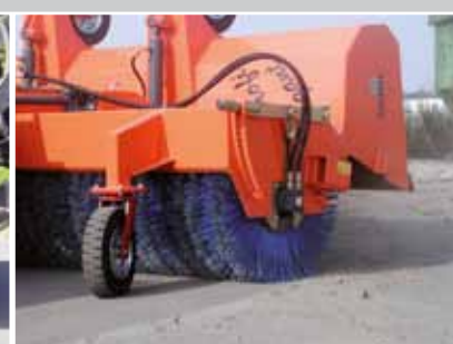
einfache Bürstennachstellung über Rasthebelsystem
