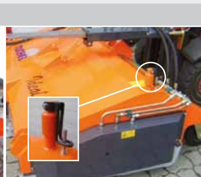
Handkurbel zum Einstellen der pendelnd aufgehängten Kehrwalze
