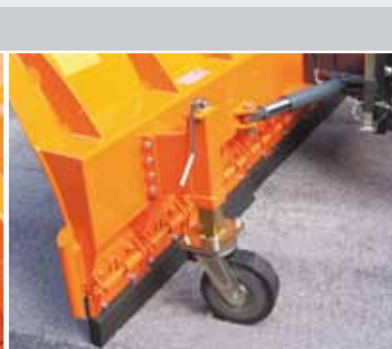
stufenlose Einstellung der Markenstützräder
