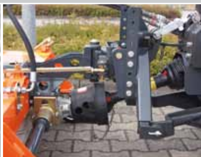
mechanischer Antrieb für Drehzahlen von 540 bis 2100 /min
