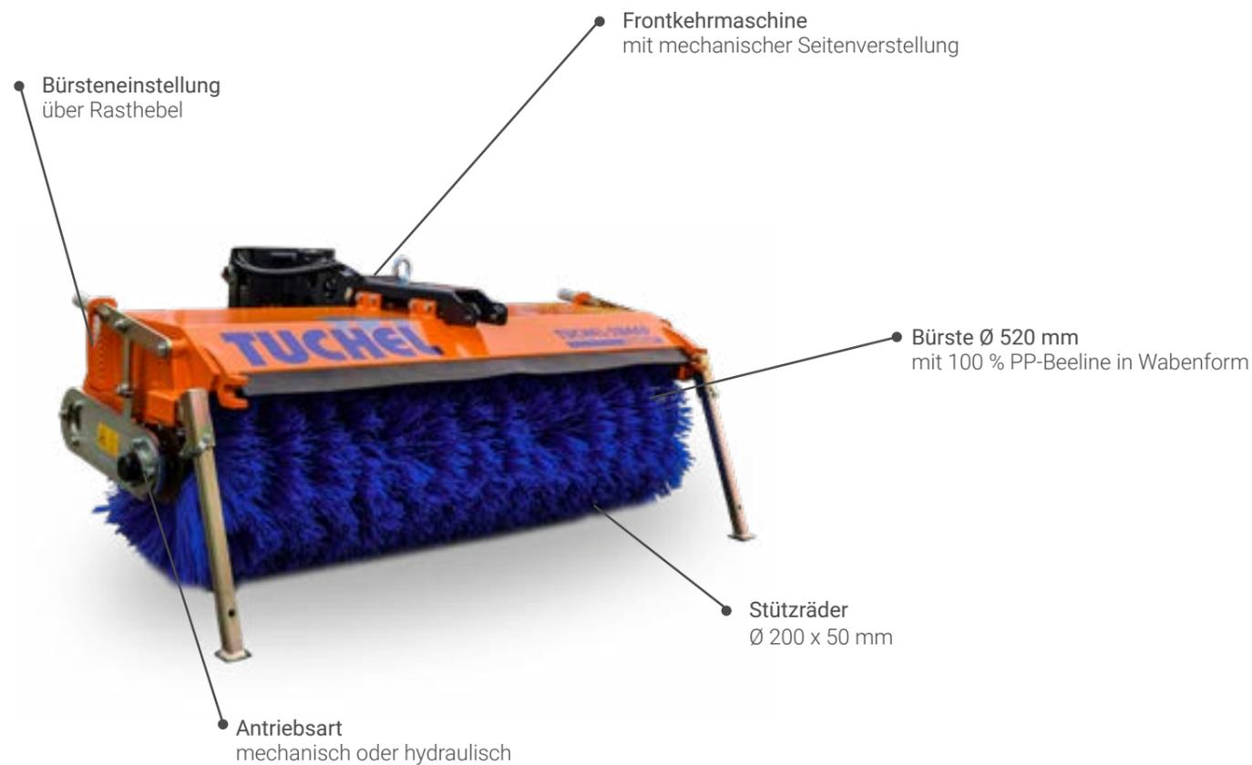
Die Frontkehrmaschine KOMPAKT wurde speziell für Kleintraktoren, Kommunalfahrzeuge und Hoflader ab 30 PS entwickelt.
