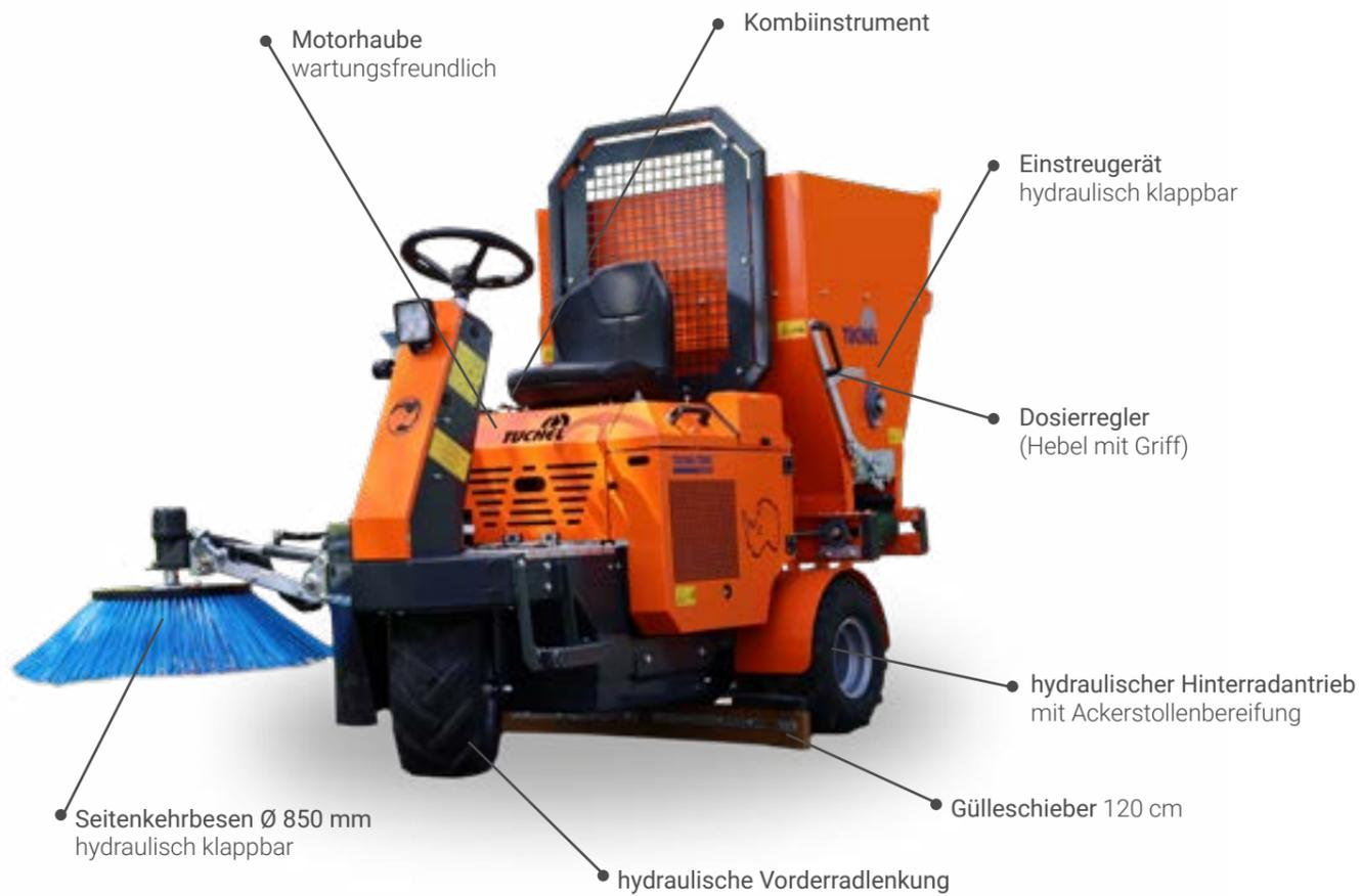
Der Tichel-Trac FarmXpert - das richtige 3in1 Fahrzeug für Milchviehbetriebe, der zeitaufwendige, schwere Handarbeit erspart und das Personal entlastet. Liegeboxen abkehren, neu einstreuen, Spalten reinigen, alles in einem Arbeitsgang.
