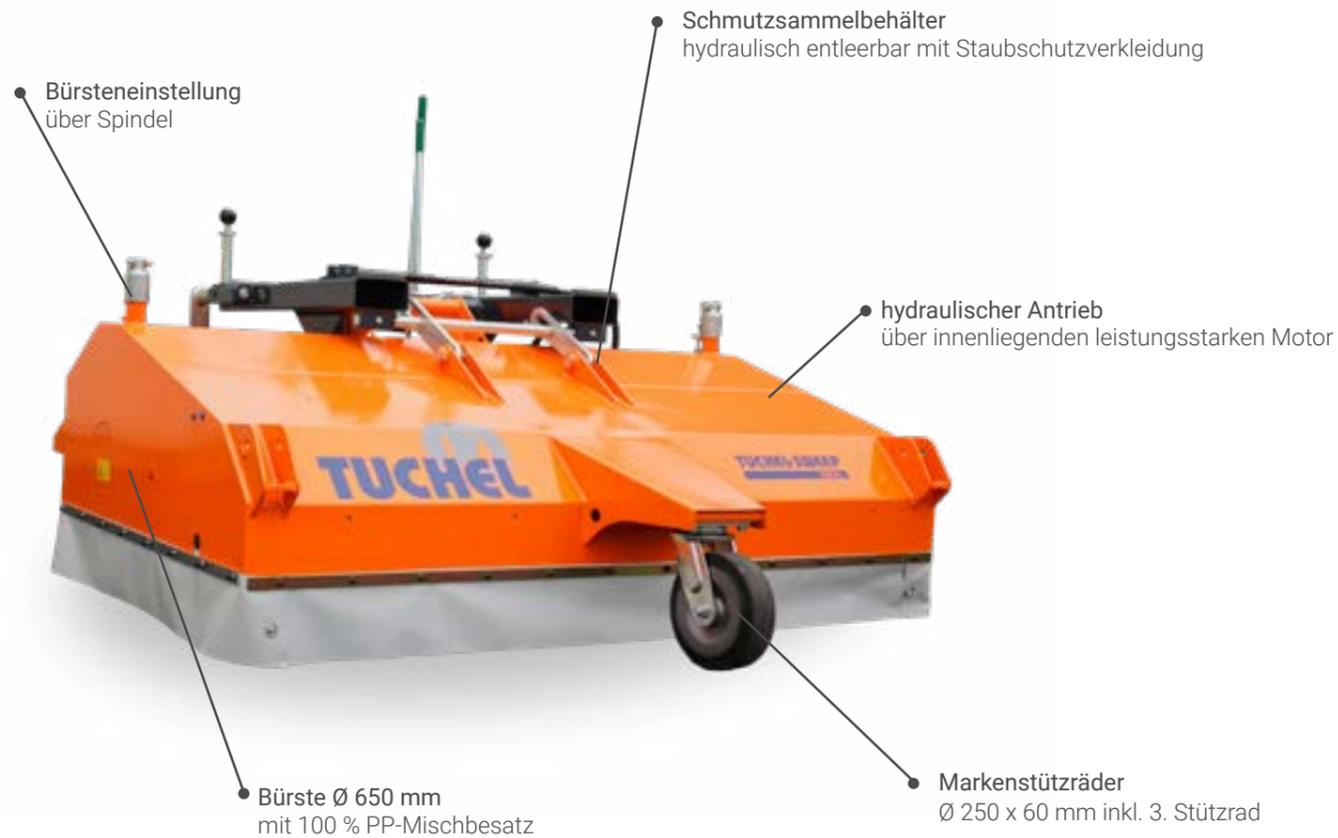
Die Frontkehrmaschine IDEAL 650 ist speziell für den Einsatz in der Industrie, im Innen- wie auch im Außenbereich, vor Gabelstapler und Radlader konzipiert. Der Antrieb erfolgt über einen innenliegenden leistungsstarken Hydraulikmotor mit Doppeldruckbegrenzungsventil.
